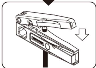
將板手壓下，使油管襯套壓入油管，油管襯套需與油管裁切面緊貼避免漏油。
