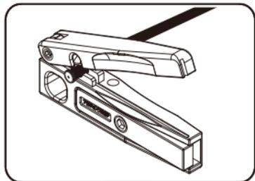
將油管平放於裁切槽，壓下板手並裁切所需油管長度，油管切口需平整且無毛邊。
