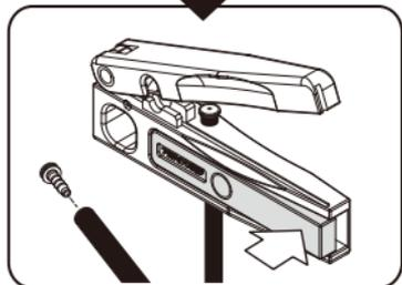
將含O行環之油管襯套置入油管，油管穿過裁切器底部圓孔，按住壓板夾住油管。
